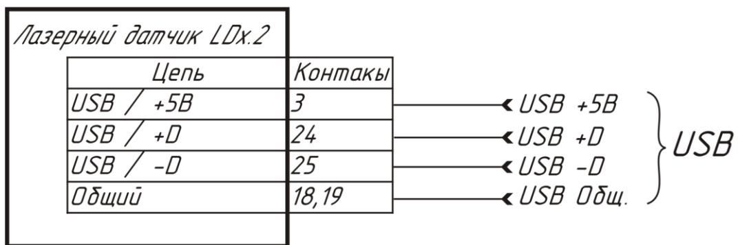
Схема подключения USB
