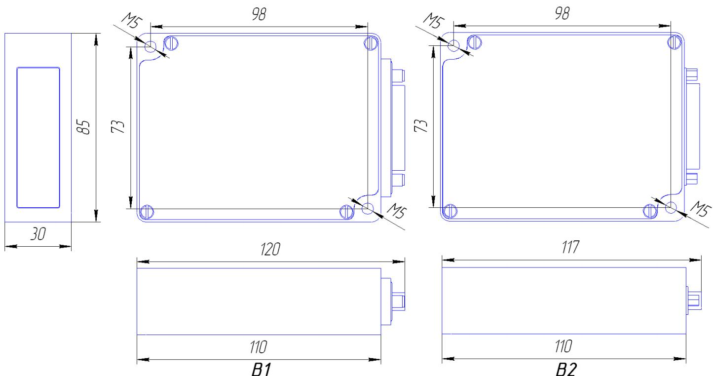
Рис 2. Габаритные размеры датчика с разъемом D-SUB25.
