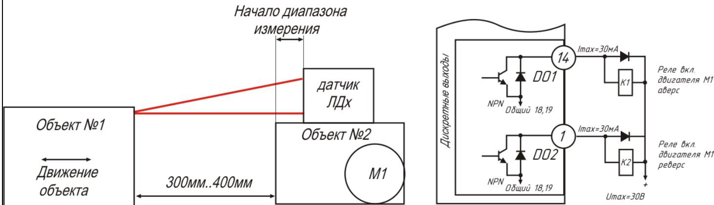
Дискретный выход DO1 конфигурируем на вкл./откл. двигателя в направлении аверс. Дискретный выход DO2 конфигурируем на вкл./откл. двигателя в направлении реверс.
