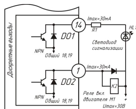
Дискретный выход DO1 конфигурируем на сигнализацию отсутствия сигнала, для информирования об ошибке. Дискретный выход DO2 конфигурируем на вкл./откл. двигателя перемещения объекта №2 с датчиком.
