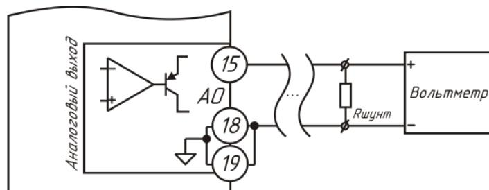
Добавление шунтирующего резистора для получения выхода по напряжению
