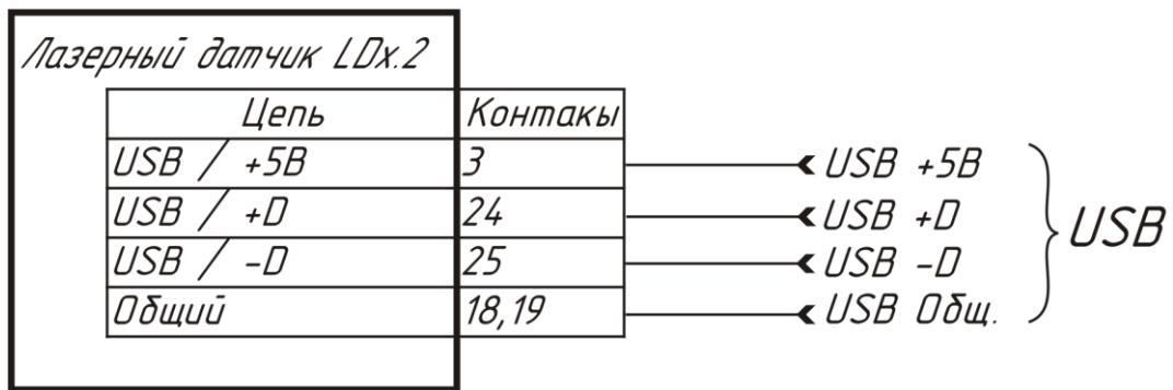
Схема подключения USB
